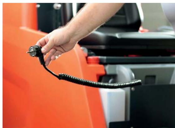
Con el cargador de a bordo, la batería se puede cargar en cualquier enchufe convencional de 220 / 230V.
