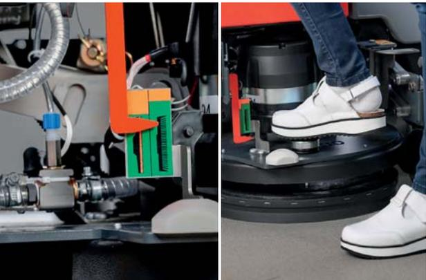
Vista general: Indicador de desgaste para cepillos y pads. Un cómodo sistema de expulsión permite el cambio rápido y fácil de los cepillos - sin necesidad de herramientas.
