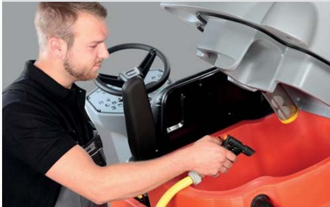
Superficies lisas en el depósito: Esto facilita la limpieza del depósito y evita que la suciedad residual se pegue a la superficie. Marcado claramente: Todos los componentes, que requieren inspección y mantenimiento regular, están marcados en amarillo.
