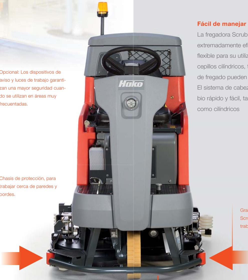
Parachoques robustos tanto en la parte delantera como en la trasera proporcionan una protección eficaz contra colisiones y una mayor seguridad.
