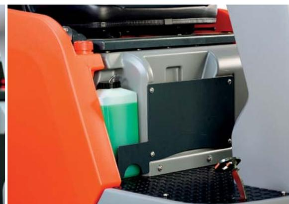
El sistema de dosificación a bordo está completamente integrado en el diseño de la máquina y asegura que se añadan cantidades óptimas de detergentes de limpieza, dependiendo de la cantidad de agua utilizada.
