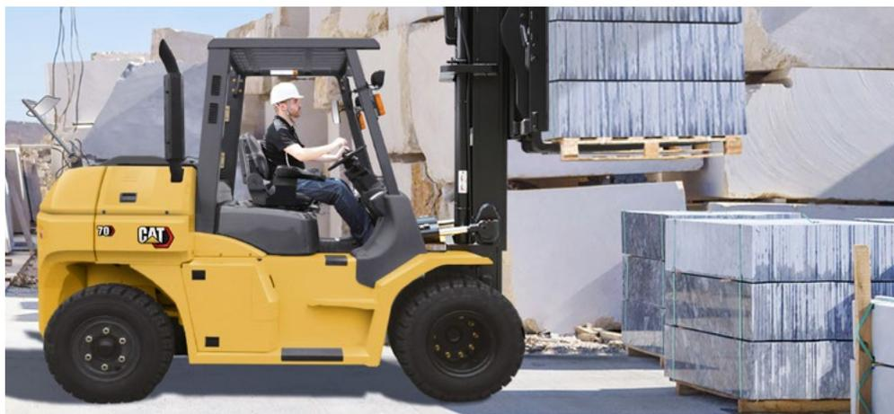
El motor diésel Common Rail de 3,8 litros suministra gran potencia sin transmitir apenas vibraciones al asiento del conductor gracias al uso de materiales de amortiguación entre el bastidor y el motor.
