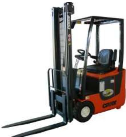
El ancho de la máquina es solamente de 850 mm, tensión batería 48 v, 2 motores de tracción de corriente continua, sistema de dirección eléctrico, ruedas traseras súper elásticas dobles: son algunas de las características que hacen que la carretilla elevadora CARER de la serie N08-10 sea de las más avanzadas del sector.
