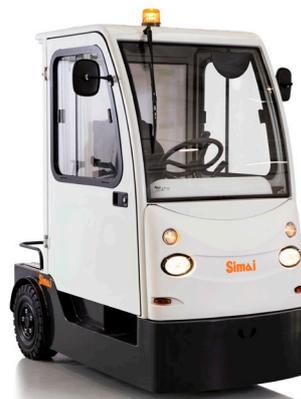
Tractor de 3 ruedas, hombre a bordo, con tracción trasera. Muy manejable, ideal para servicios intensivos tanto en interiores como en exteriores. "AGV ready"
