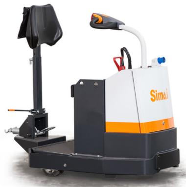
Tractor de 3 ruedas, con dispositivo "hombre presente" y tracción delantera. Extremadamente veloz, compacto y fácil de manejar, resulta ideal para transportar cargas pequeñas a corta distancia, por el interior de espacios industriales.
