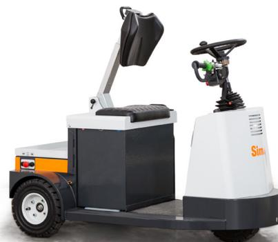
Tractor de 3 ruedas, con dispositivo "hombre presente" y tracción trasera. Extremadamente compacto y fácil de manejar, es ideal para trabajar con arreglo a los métodos Lean.
