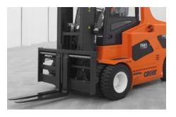
operador. Montada sobre un sistema de silent block, reduce al máximo las vibraciones y la rumorosidad. Desde el puesto de conducción se domina perfectamente todo el espacio de alrededor y todo el perímetro de la máquina es fácilmente perceptible. La visibilidad sigue siendo buena incluso con la manipulación de cargas voluminosas, garantizando al operador una óptima posición de conducción con una máxima visibilidad aumentando el grado de seguridad.
