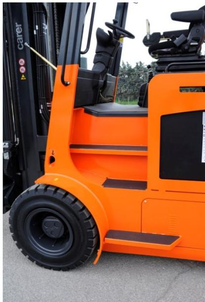
El amplio asiento es con suspensión, regulable en varias posiciones incluso en base al peso del conductor.
