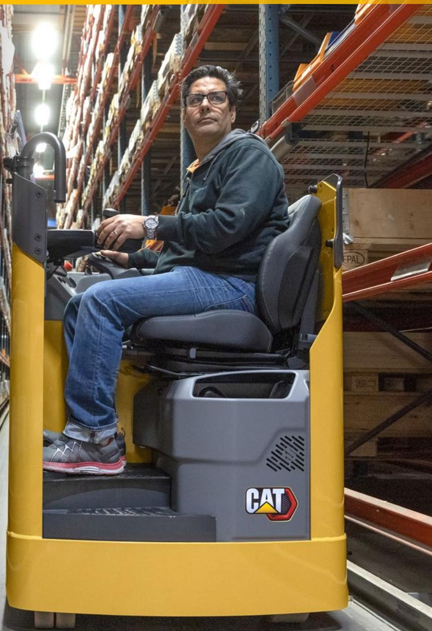
**CON DISEÑO ERGONÓMICO PARA OPERACIONES INTENSIVAS DE TRANSPORTE INTERNO, ESTAS POTENTES TRANSPALETAS PUEDEN DESPLAZAR RÁPIDAMENTE CARGAS PESADAS Y LARGAS A GRANDES DISTANCIAS.**
